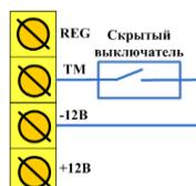
Рис. 9.1. Схема подключения скрытого выключателя
