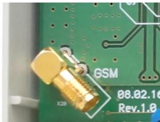
Рис. 4.3. SMA-разъем для подключения GSM-антенны
